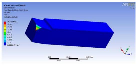
Max. Stress → 19.152 N/mm<sup>2</sup> & Min. Stress → 6.339 x 10<sup>-7</sup> N/mm<sup>2</sup>
