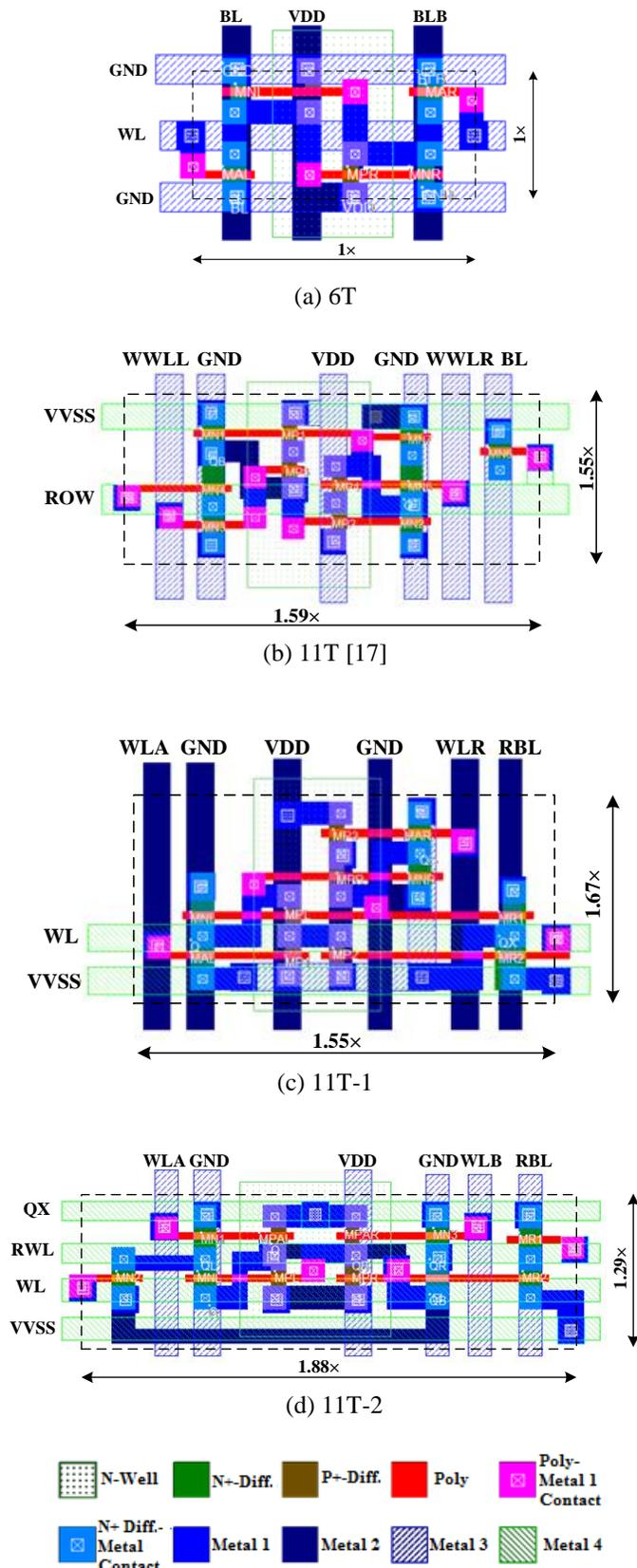
Fig. 18. Layout of (a) 6T, (b) 11T [17] (c)11T-1 (d) 11T-2 SRAM cells.
